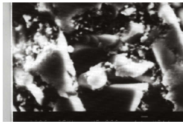
شکل ۲. تصاویر SEM نمونه‌های GdPrCa-123 (الف) (z=0/15) و (x=0/15) ، (ب) (z=0/2) و (x=0/3) ( \times 5000 ).
